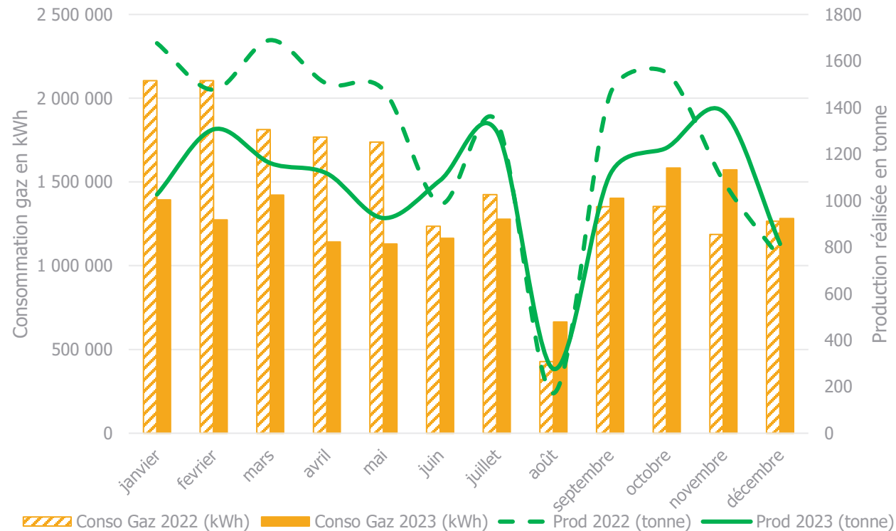
Consommation de gaz en fonction de la production réalisée entre 2022 et 2023
