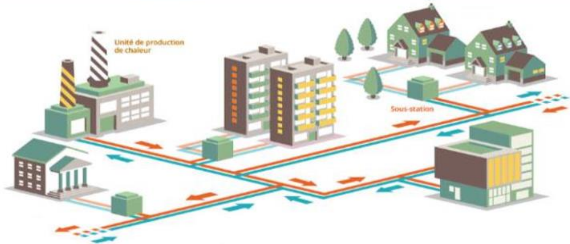
Schéma de principe d'un réseau de chaleur (Source ADEME Île-de-France)
