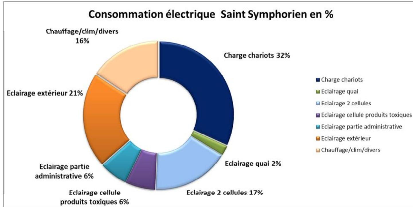
Cette répartition est issue des relevés des puissances et des pratiques, le chauffage/climatisation est issu de la différence entre l'ensemble des autres postes et la consommation générale de facturation. Il n'y a pas de mise hors gel des cellules.
