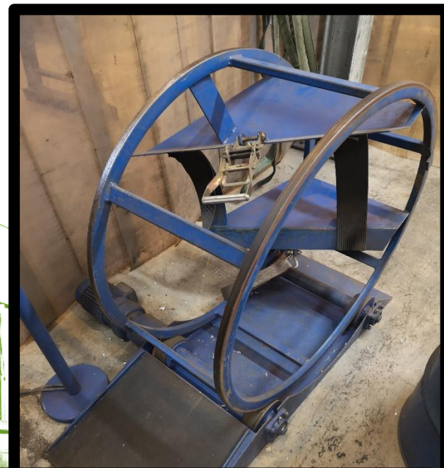
Le retourneur mélangeur de fût homogénéise les échantillons de concentrés de métaux.
